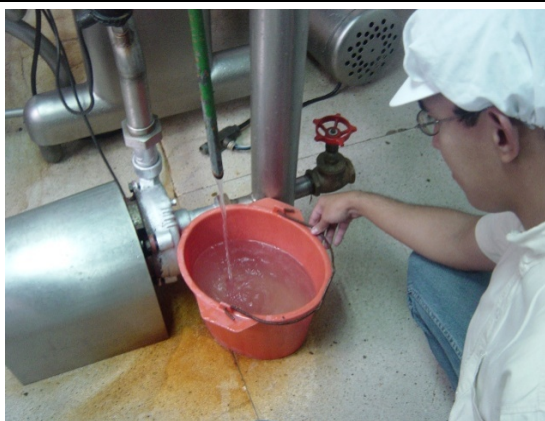
Hình 6: Đo lưu lượng nước bằng xô và đồng hồ đếm thời gian
